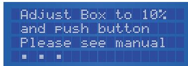
El ventilador no está funcionando o se ejecutará muy lentamente. Gire el botón hasta que sienta que el ventilador está en el 10% de su velocidad máxima. De esta manera, usted puede decidir la cantidad de energía que se necesita para el 10%.
