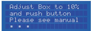
Der Ventilator läuft nicht oder läuft nur sehr langsam. DDK drehen, bis Sie das Gefühl haben, dass der Ventilator auf 10% der maximalen Geschwindigkeit läuft. Auf diese Weise können Sie entscheiden, wie viel Energie für 10% erforderlich ist.
