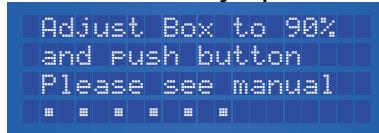
El ventilador funciona lentamente. Gire el botón lentamente hasta que el ventilador detenga el aumento de la velocidad. Esta es la velocidad al 100%. Gire el botón hacia atrás hasta que sienta que el ventilador está al 90% de su velocidad máxima.
