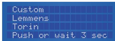
Coloque la flecha en la parte delantera de su marca girando el botón. Si usted tiene un ventilador que no sea Lemmens o Torin, elija Custom. Pulse el botón para confirmar.
