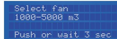
Der gewünschte Ventilator kann durch Drehen der DDK ausgewählt werden. Ihre Auswahl wird als Standard eingestellt. Diese Ventilator Einstellung wird beim Neustart des Clima Control Plus verwendet.
