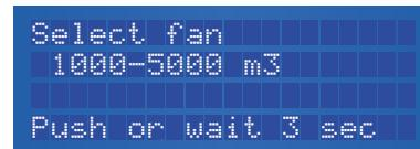
Le ventilateur désiré peut être sélectionné en tournant le PTB. Votre sélection est définie par défaut après une pression sur le bouton.
