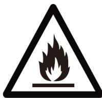
Този символ предупреждава за възпламеними материали. Уредът е предварително зареден с възпламени хладилен газ пропан R290. При нарушенна херметичност на хладилната система е възможно изтичане на газ. В контакт с отворен огън, искра или нагорещена повърхност, този газ може да се възпламени и да предизвика пожар.
